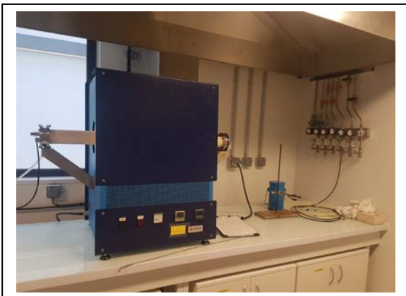
Four sous atmosphère : Tmax = 1500°C
