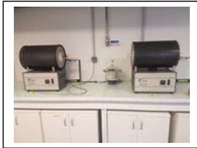
Fours à calcination : Vecstar Tmax = 1100°C
