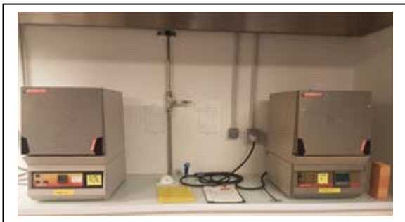
Fours à calcination : Vecstar Tmax = 1100°C
