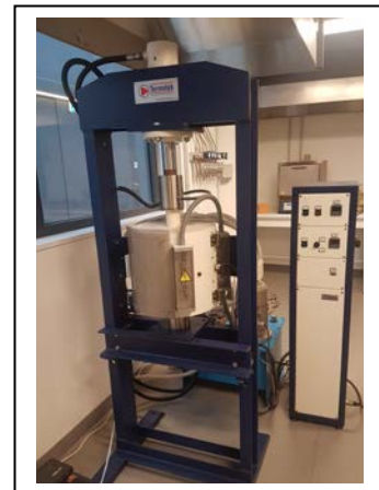
Four sous charge : Tmax 1350°C et Pmax= 150KN
